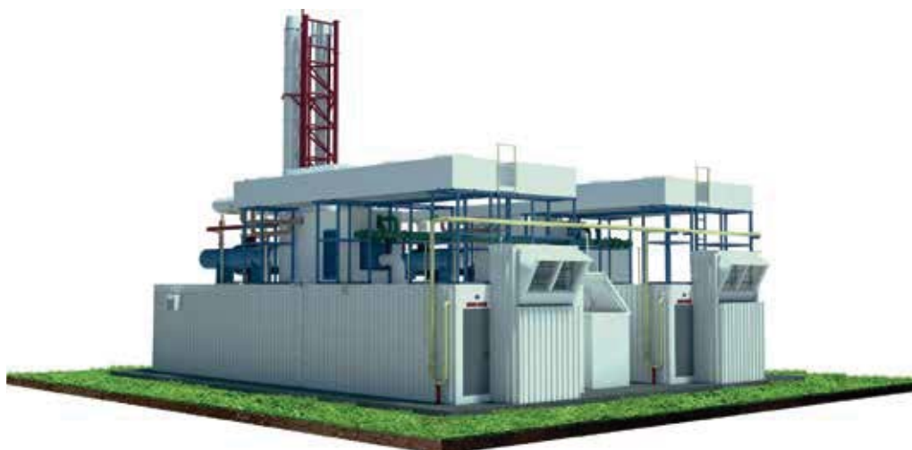
Рис. 4. 3D-модель мини-ТЭС в блочно-модульном исполнении
