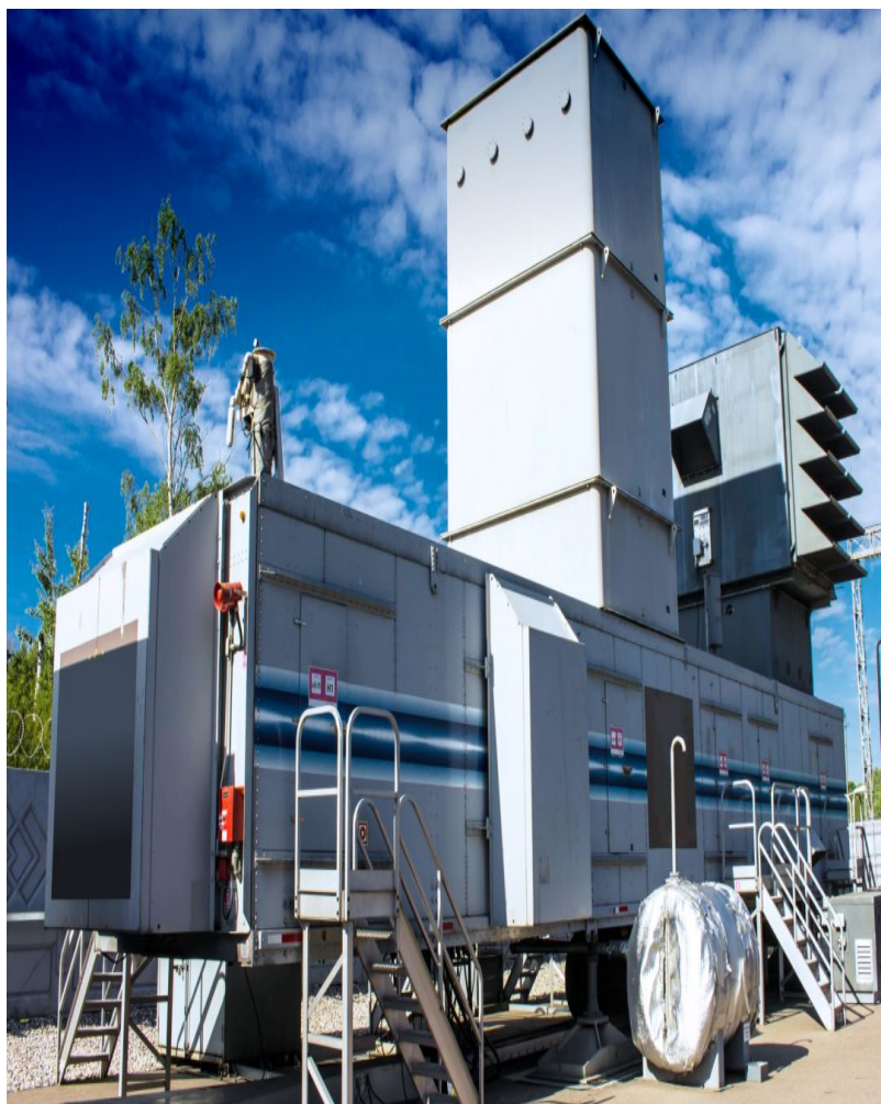
Передвижная газотурбинная электростанция
