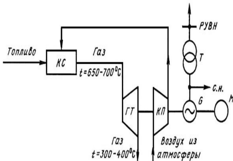
Принципиальная технологическая схема электростанции с газовыми турбинами:
