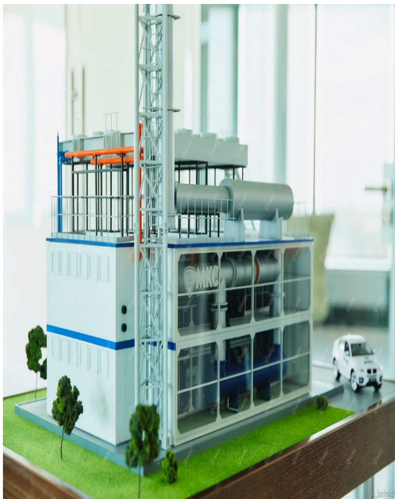
визуализация в архитектурном макете блочно-модульной станция 4,5 МВт
